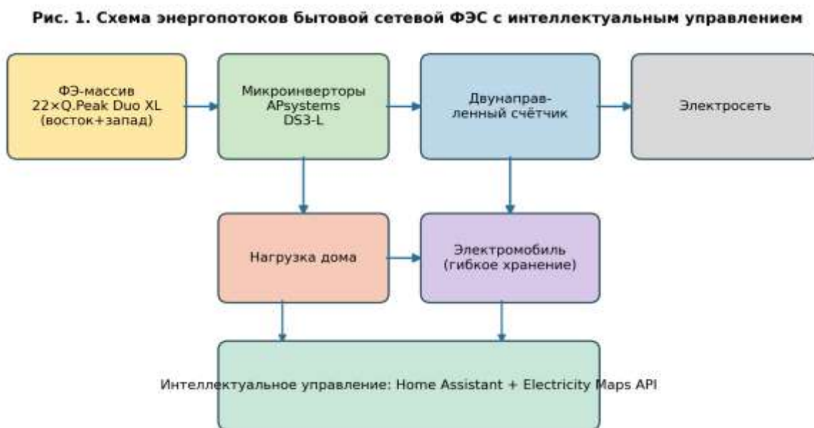
Рис. 1. Схема энергопотоков бытовой сетевой ФЭС с интеллектуальным управлением
