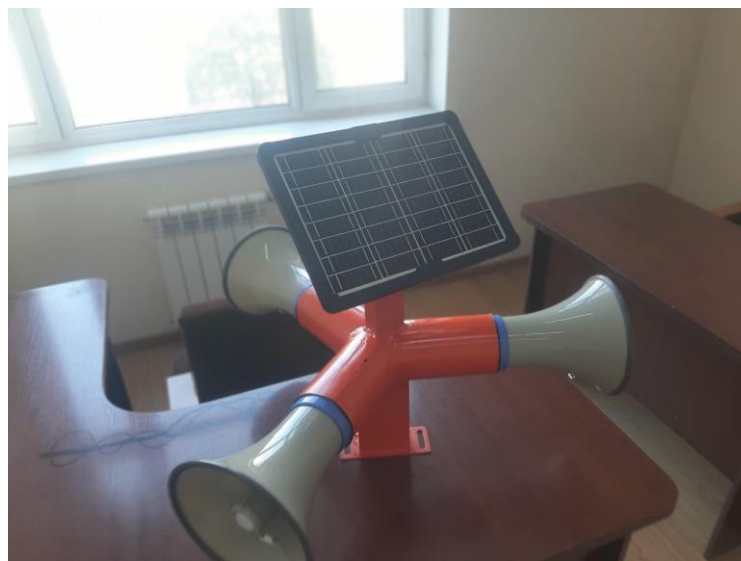
2-rasm: Favqulodda vaziyatlarda aholiga xabar berishning zamonaviy “Map-kom” qurilmasi.
