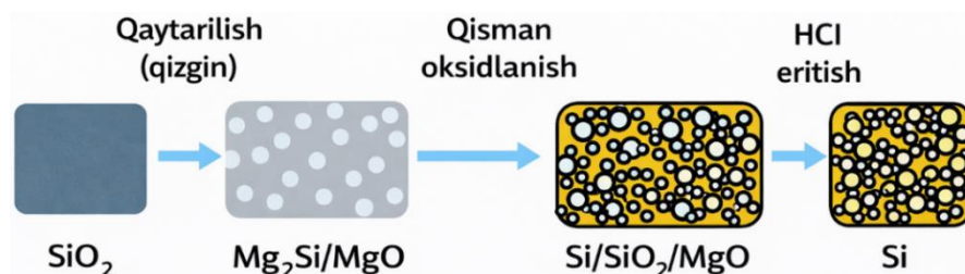
6-rasm. \text{SiO}_2 ni magnioterмик qaytarish asosida kremniy olish jarayonining sxematik tasviri: chuqur qaytarilish ( \text{Mg}_2\text{Si} va \text{MgO} hosil bo'lishi), \text{Mg}_2\text{Si} ning qisman oksidlanishi hamda kislota eritmasida tozalash bosqichlari.
