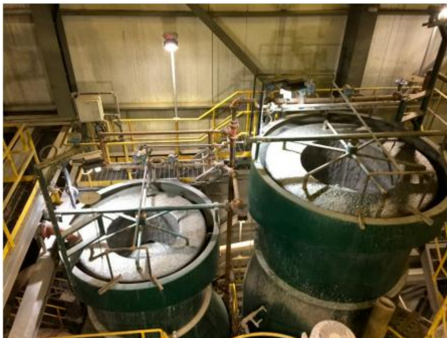
Рисунок 2. Фото реальных флотационных ячеек с перерабатывающего завода (фото сделано авторами).
