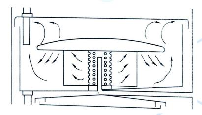
Рис.4.2. Барботажное устройство в конструкции Вотэйтора (маммут-насос)
