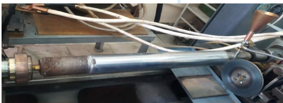
1-rasm. Valni yuzasiga qoplama qoplash jarayoni
