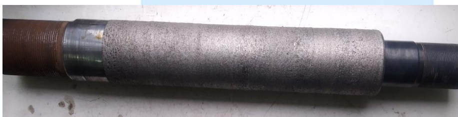
1-rasm. Valni yuzasiga qoplama qoplash jarayoni
