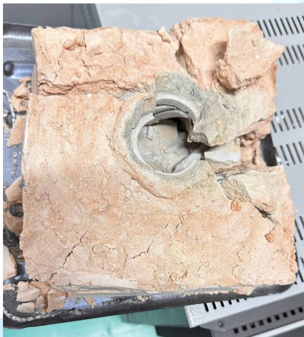
Рисунок. 1. Внешний вид разрушенной оболочковой формы после термообработки при 600^\circ\text{C} : видны трещины, отслоения и локальные обрушения, вызванные дегидратацией связующего и термо-механическими напряжениями.
