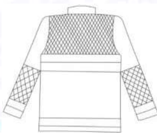
2- расм. Ўт ўчирувчилар махсус кийимининг емирилиш топографияси
