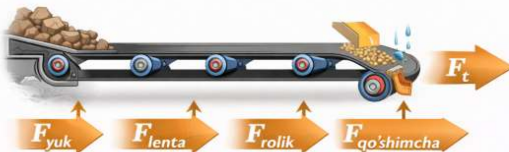
1-rasm. Lentali konveyerda tortish kuchlari balansining strukturaviy sxemasi
