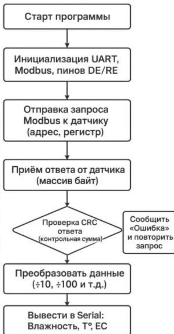
Рис.7. Блок-схем алгоритма управления объекта.
