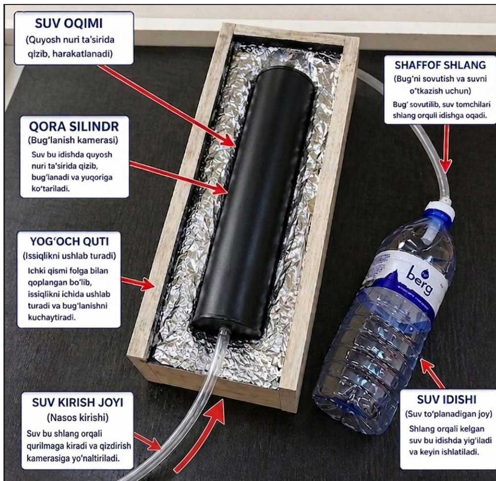
1-rasm: Harorat farqi asosida ishlovchi elektrsiz suv ko'taruvchi mini-nasos
