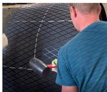
3-расм. Барабанга футеровкани ёпиштириш ва болғалаш
