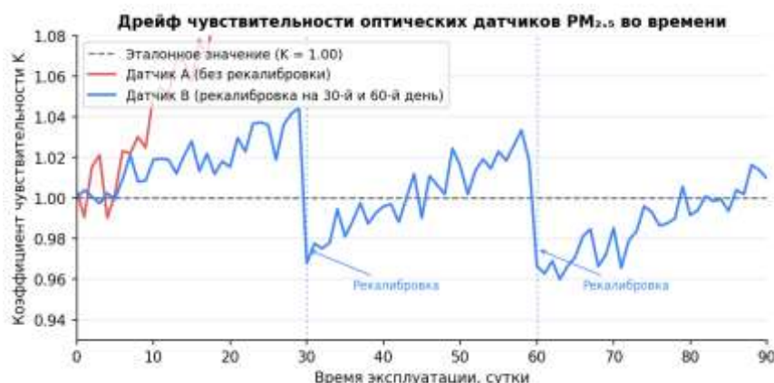
Рисунок 2. Дрейф коэффициента чувствительности K двух оптических датчиков PM 2.5 за 90 суток непрерывной эксплуатации. Датчик A эксплуатировался
